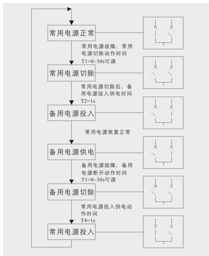
电网-电网型自投不自复功能逻辑图
